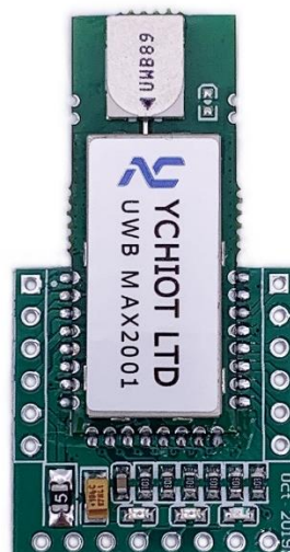
图 1.4 MAX2001-CA 在转接板上的焊接实物图
