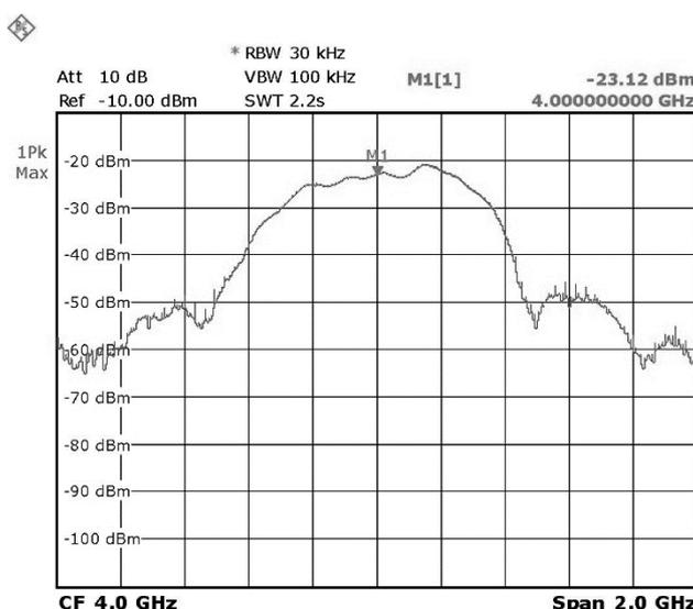
图 1.3.5 发射功率测试
