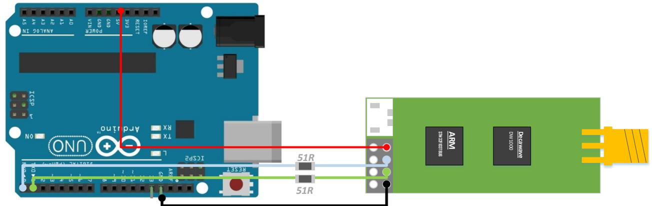
图 6.3.1.3 UWB Mini3s 模块与单片机(Arduino)相连
