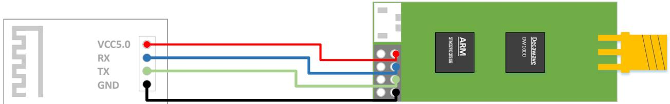
图 6.3.1.2 UWB Mini3s 模块与蓝牙模块相连
