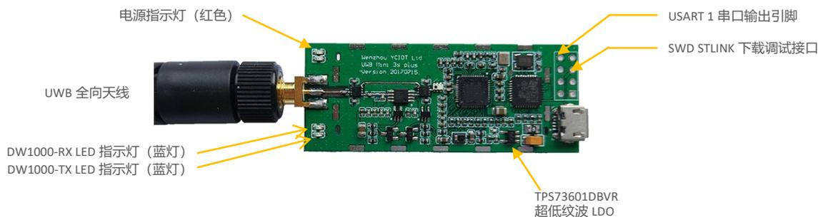
图 1.3.1 UWB Mini3s Plus 正面图
