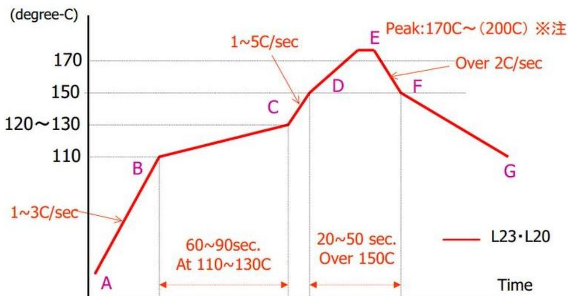
图 6.3 MAX5007 模块回流焊温度曲线
