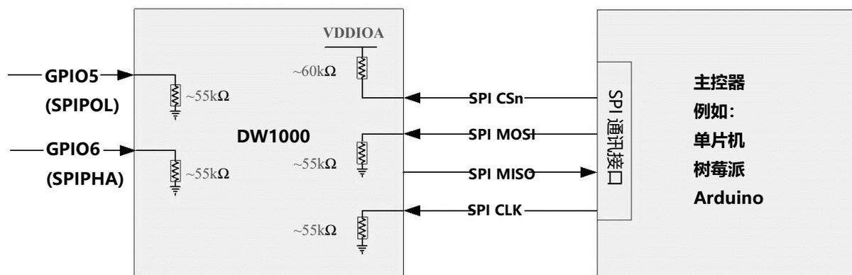
图 5.1.1 SPI 总线的连接示意
