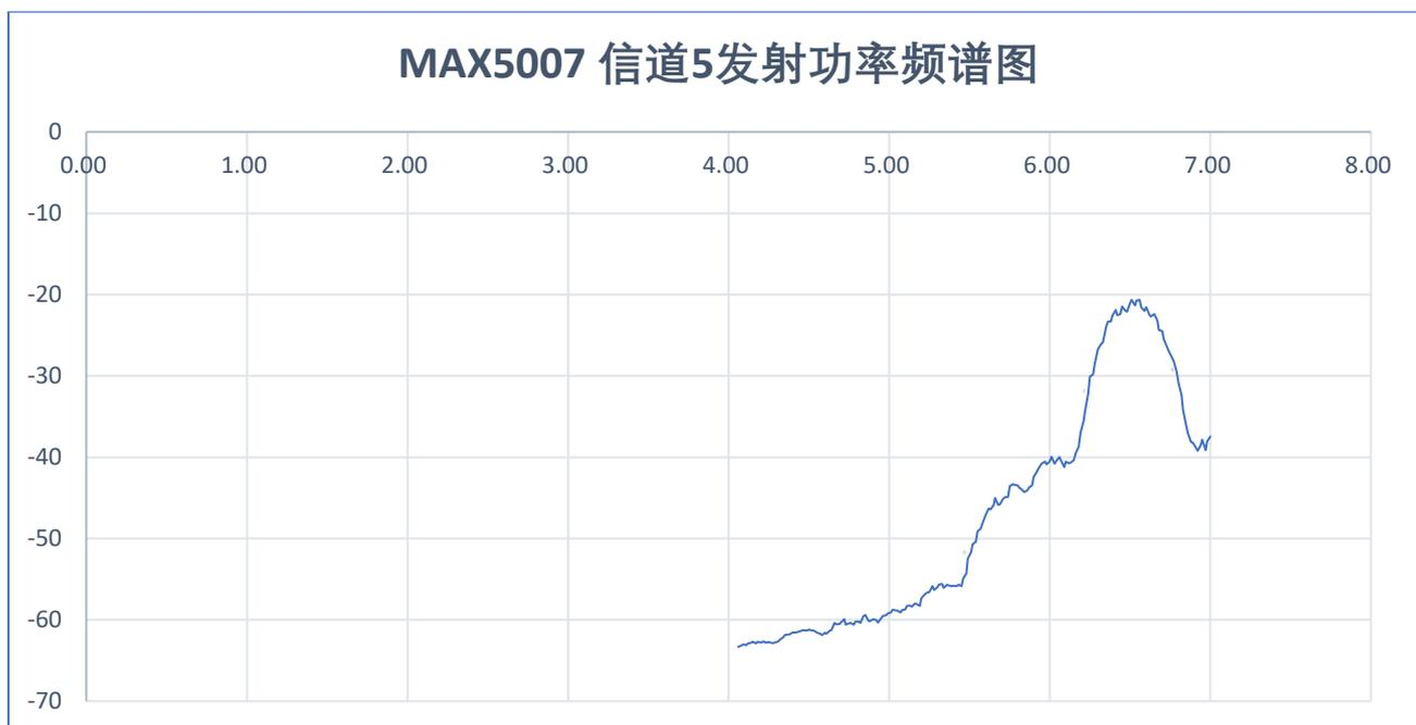
图 4.6.2 MAX5007-SMA 发射功率 (横坐标: Ghz, 纵坐标: dbm/Mhz)
