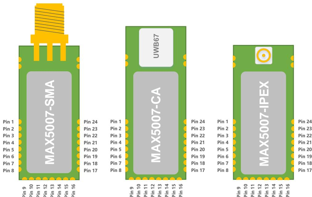
图 3.1.1 MAX5007-SMA / CA / IPEX 引脚图
