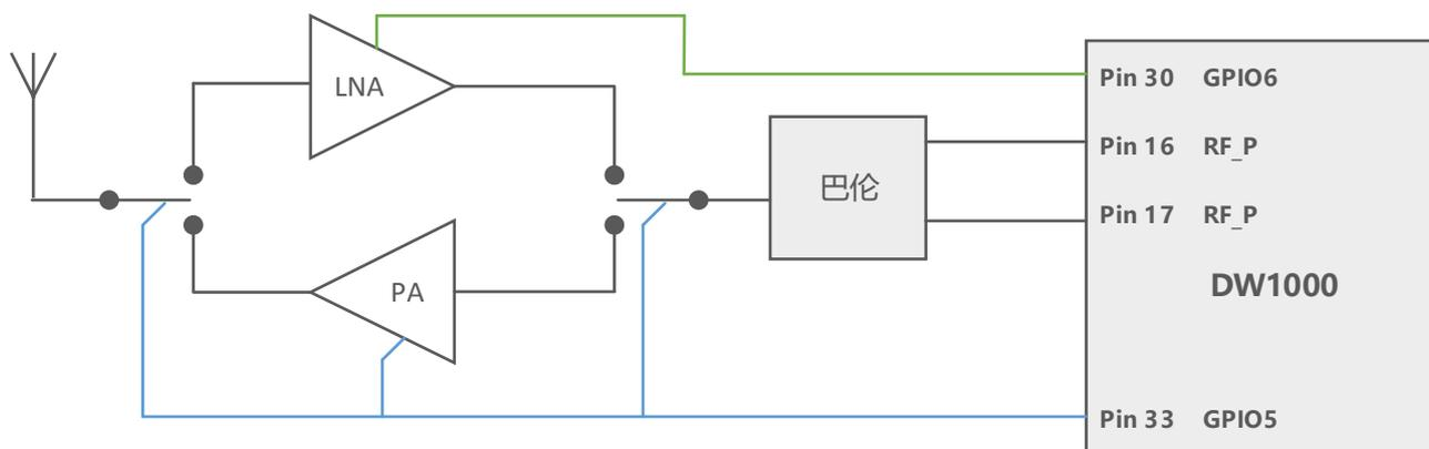
图 5.3 PA 与 LNA 工作原理示意图
