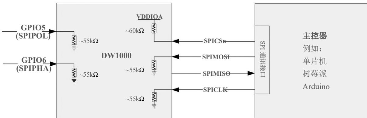
图 5.2.1 SPI 总线的连接示意
