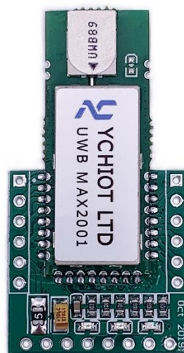
图 1.4 MAX2001-CA 在转接板上的焊接实物图
